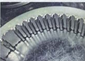
▲摩耗したスリーブのチャンファ部。
