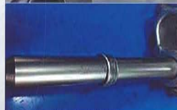
上2枚：ノーマルブッシュの摩耗箇所。 下：摩耗した為にシャフトと共に抜けてしまったブッシュ。
