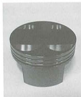
図10 作製したDLC被覆アルミニウム合金製ピストンの外観写真
