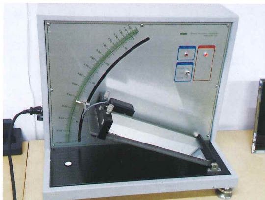
レール：SUS304、摺動物：PET樹脂で評価。 レーザー加工品は鏡面レールに対して低摩擦化、傾斜角度を 14^\circ から 8^\circ に改善した。
