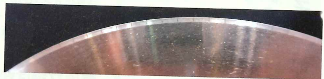
機械要素技術展で出展されていた、超短パルスレーザー加工を施した丸刃の刃先(切欠きが確認できる)
