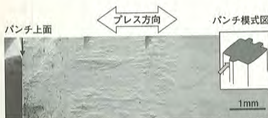
図5 未処理金型の5万ショット後の損傷状態 (SEM観察)
