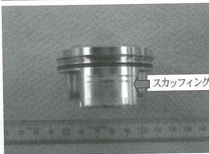
低シリコン A2618 耐熱アルミ合金製 シリンダーボア：Ni-P メッキ
