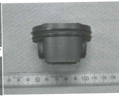
A2618 ⇒ W ピーニング + 凸部研磨 + P-CVD, DLC シリンダーボア：P-CVD, DLC
