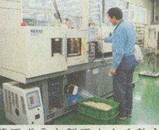
1秒成形は生産効率向上に大きく寄与する。1秒成形を実現するために、金型構造や成形条件を洗い出し、成形時間を短縮し、成形材料の流動性を向上...
