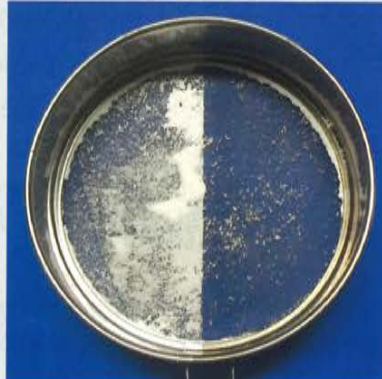
左:未処理 右:MiCRO DiMPLE処理 網にも処理可能
