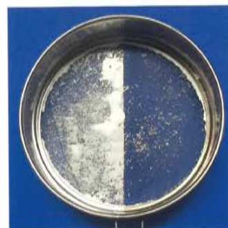
写真2 MD処理(右半分処理)を施したふるいの金網例
