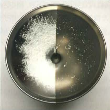
左:未処理 右:MiCRO DiMPLE処理 粉の付着抑制
