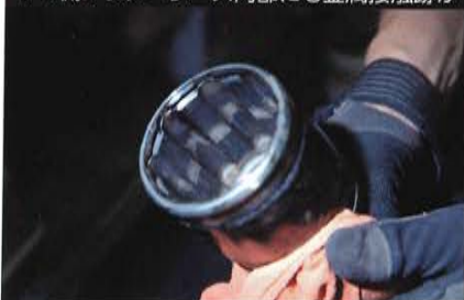
デフ側アウターレース内部にも金属接触跡が
