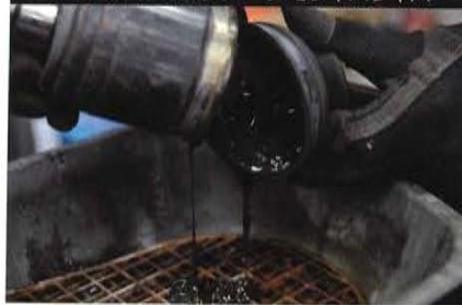
デフ側アウターレース内部にも金属接触跡が
