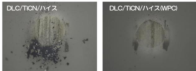
図 12 密着性試験後の ball の表面観察結果
