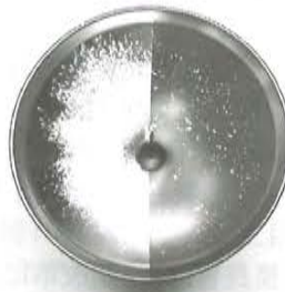
ホッパーの右側へのみWPC処理®を施した。粉の付着が全然違う!
