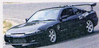
「中山サーキットは全体的にタイトで路面μが低く、本来は荷重移動を利用したマシンコントロールが非常に難しいところ。ところが、カーツのLSDに交換することで、ブレーキングからターンインでのアンダーが完全に払拭。切り込んだ瞬間にフロントが反応し、適度にリアが追従するニュートラルステアに改善されている。もともとS15シルビアはフロントヘビーで初期の応答性が悪く、アンダーオーバーの差が激しいクルマ。そんなS15でも進入でしっかりと向きを変え、ベストなラインを狙えるようになるのだから、交換する意味は大きいと思うよ」
