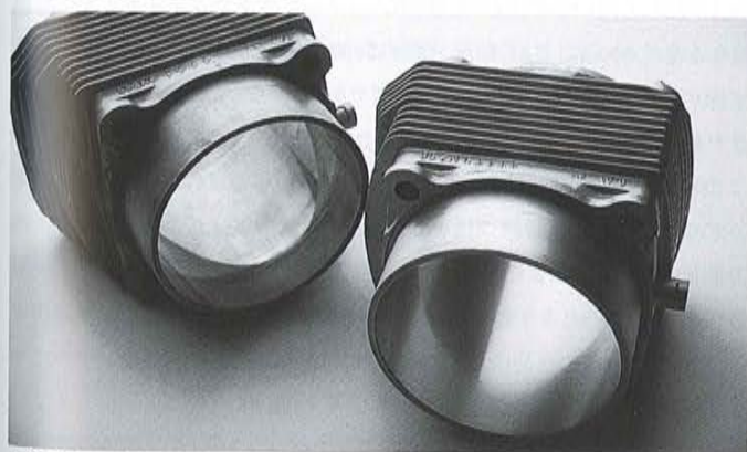
手前が再メッキ処理後、奥が加工前のシリンダである。見た目の仕上がりから異なるが、膜厚の厚いコーティングによって寸法精度がピストンに最適化されることが重要だ。
