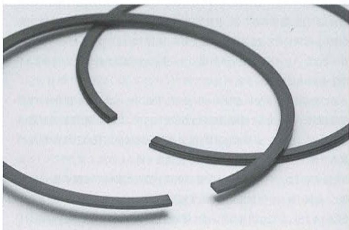
ピストンリングへのDLCは効果的。溝内での摺動抵抗が小さくなることでリングのボア追従性が良くなり、密閉性が向上する。
