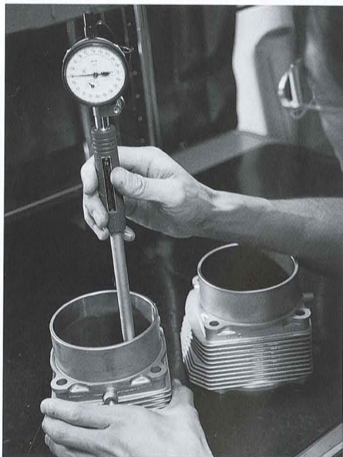
水平対向エンジンなので、縦方向と横方向で摩耗の度合いが異なる。サンプルの計測では30ミクロンの差、これを再加工によって真円に対し15ミクロン差に納めるようにする。
