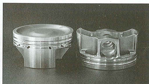
ボア径100φのEJ25用鍛造ピストン。ショートスカート設計の特注品で、サ ーキット専用として開発することで、ピストン自体は1000ps対応という強 度を持つ。また、組み合わせるシリンドーヘッドやタービンによって、トップボ リューム(冠面のへこみ具合)やスカートの長さなども最適化される。
