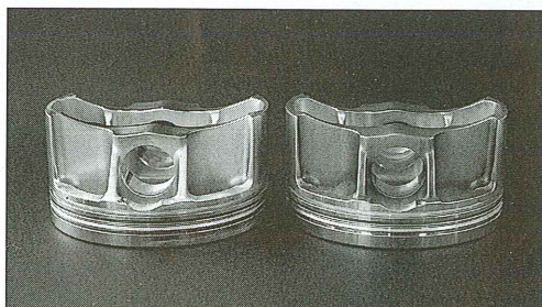
いずれもEJ25用鍛造100φピストン。形状は全く同じだけど、左のサーキ ット用はSPL材を、右のストリート用はA2618材を使うなど素材が異なる。 これは使用環境に応じて強度や膨張率の調整を行うためで、プロファイルが 微妙に違っている。
