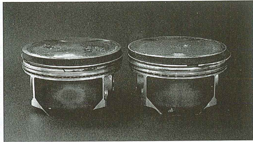
どちらも純正ピストンで、左はセカンドランド部がタナ落ちしたもの、右が普通にスポーツ走行を行ってきた車両のもの。純正ピストンにトラブルが発生するのは、ピストン自体の強度不足でなく、燃焼状態をしっかりと管理していないことに大きな原因がある。
