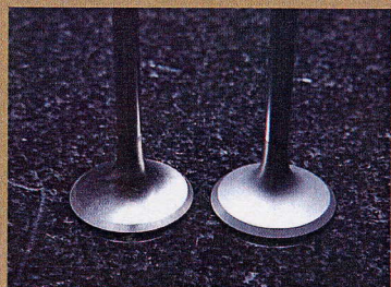
右が二硫化モリブデン処理後。1ミクロンの中に1600枚もの層が重なっている。打ち込みにノウハウがあり国内でも確実に処理が施せる会社は数少ないのが現実
