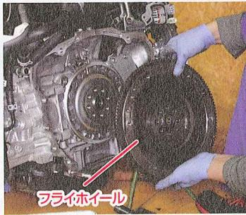
高回転エンジンらしく、フライホイールのボルトは8本ある。ボルトを抜き取ってから手でしっかりと持って引き抜く。クラッチのパイロットペアリングはボールペアリングだ。
