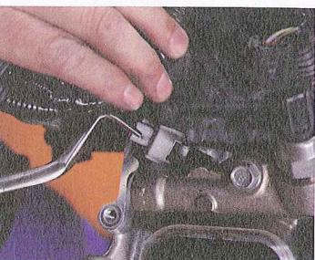
高回転エンジンは振動も激しくなるので、コネクターの信頼性が重要。水平対向だと熱が上にくるのでその対応も必要だろう。そのためロックはガッカリで手では外しにくい。
