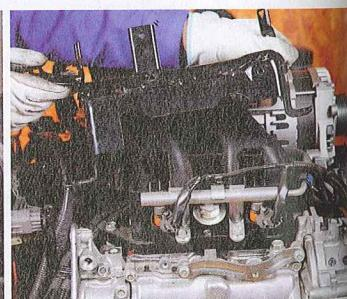
機器類やカバー、ハーネス類を外す。ハーネスは固定部に樹脂クリップが多用されているのでラジペンでつまんで外す。右はインジェクターカバー(分厚い鉄板)の取り外し。
