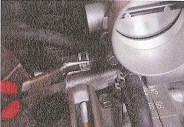
スロットルボディはアルミ製で、樹脂インマニに4本のボルトで取り付けられている。まずは、温水回路（冬季の高湿度における凍結防止。冷却目的ではない）のホースを取り外し、それから本体を外す。スロットルバルブは綺麗な状態だ。
