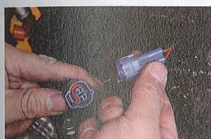
場所が分かりにくい写真だが、インマニの下側にある圧力センサー用のコネクターだ。センサー自体はインマニに装着したまま外すことが可能。
