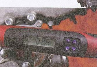
エンジン分解前にトルクレンチで簡単に空転トルクを計測。軽いエンジンだと14~16Nm程度だが、これは最大23Nmで少し重い印象を受ける。高回転対応のバルブスプリングなどによる影響なのかも。今回はここまで。次回は完全分解へ進む予定だ。
