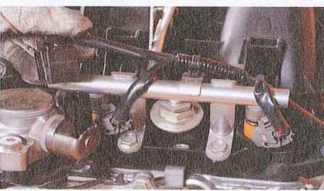
こちらはポート噴射のデリバリーパイプとインジェクターで駆動取りのバルセーションダンパーも見える（真ん中の丸い部品）。コネクターを外す。
