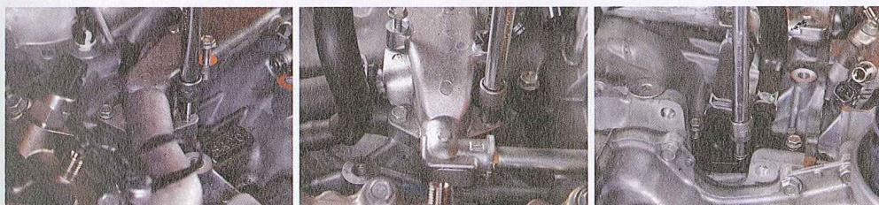
(左)同じくシリンダーブロックの左右を横断するクーラント通路のアルミパイプを外す。(中央)ウォータージャケットに繋がっているようだ。(右)左バンクのウォーター/PCVホースを外す。全く用途の違う2つの回路部品を一体としている。
