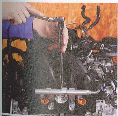
インマニの取り付けボルトを緩める。ポート噴射のインジェクターは付いたままで、深い部分にボルトがあるため、マグネットで引き上げる。
