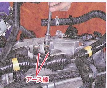
左はノックセンサーのコネクター外し。センサーの向きを固定するものはないので、センサーを外す際に向きの記録が大切。右はアース線2本の取り外し。
