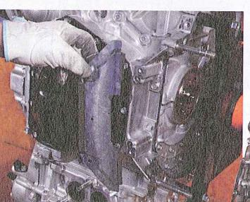
エンジンマウントの取り外し。エンジン側は樹脂製のプラケットだ。これはEJ時代からも使用していたと思う。直列エンジンと違いエンジン後端にマウントがある。
