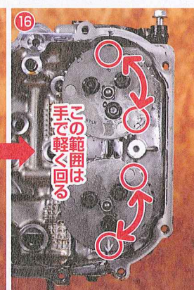
12 13 クランクを200度右回転させて、キーが真下を向くようにする。これによりすべてのピストンが中央付近になる。14 インテーク側のカムを180度回転させ、▲マークが65度付近に向くようにする。15 この作業で吸排気バルブがすべて閉じた状態となる。16 では安全マージンを持って180度回したが、▲マークが真上から右側にあればOK。16 タイミングギヤASSYを手で回すと、15での範囲から写真の位置まで軽く回せて、どのバルブも動かしていないことが分かる。
