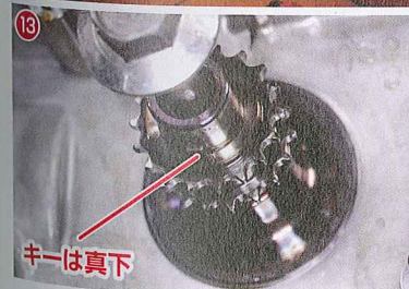
12 13 クランクを200度右回転させて、キーが真下を向くようにする。これによりすべてのピストンが中央付近になる。14 インテーク側のカムを180度回転させ、▲マークが65度付近に向くようにする。15 この作業で吸排気バルブがすべて閉じた状態となる。16 では安全マージンを持って180度回したが、▲マークが真上から右側にあればOK。16 タイミングギヤASSYを手で回すと、15での範囲から写真の位置まで軽く回せて、どのバルブも動かしていないことが分かる。
