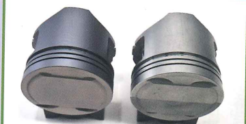
左は WPC 処理+ハイパーモリシット（磨き工程）。右は下側が WPC 処理のみ、上側は未処理のピストン
