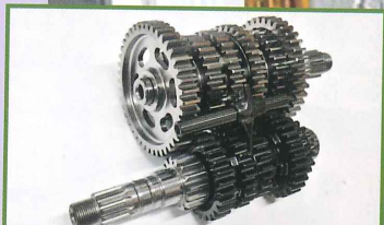
黒い方は WPC 処理+3D ラッピング（磨き）+DLC コーティング、もう片方は WPC 処理を施した GPZ900R 用ミシオン
