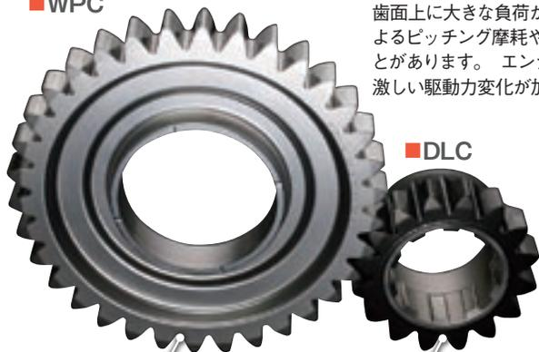
トランスミッションやディファレンシャルのギヤは、歯面上に大きな負荷がくり返し加わり、表面の疲労によるピッチング摩耗や、それを起因として破損することがあります。エンジンをパワーアップしていたり、激しい駆動力変化が加わるマシンでは、リタイヤの原因にもなります。不二WPCでは、WPC処理とDLCコーティングのギヤを組み合わせることで、良好な初期なじみ性と高い耐久性を持たせることに成功しました。写真のフォーミュラニッポン用ギヤでは、従来頻繁な交換を必要としていましたが、繰り返し実戦投入できるようになりました。
