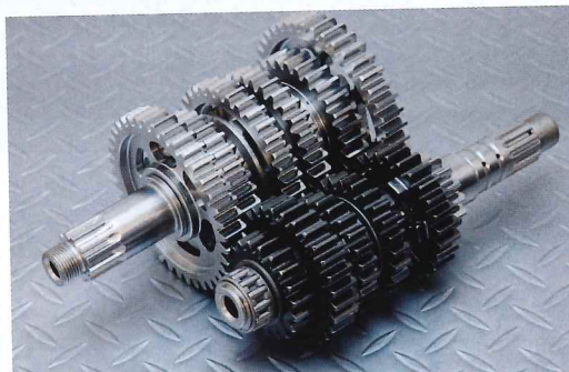
④ ミッションギヤなど、二つの部品がかみ合うパーツはどちらかのみ施工する。両方に行なうと逆に両方をキズ付けたり、なじむまで時間がかかり、本来の性能が引き出しにくくなることもあるためだとか
