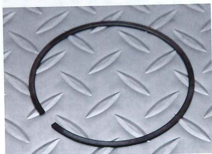
⑤ ピストンリングもトップ、セカンドとあればトップなら施工可能。セカンドはオイルをかき出す役目があり、強度がありすぎるとその役目はたぎなくなってしまうためだ
