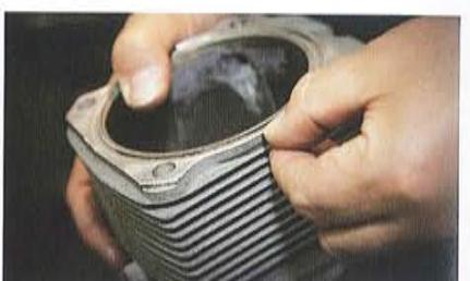
シリンダーブロックのフィンが薄く、圧縮を挙げるとねじれてしまう。
