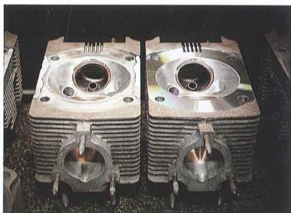
左が研磨前。右が研磨後。研磨によって水平を出し、圧着性を高める。
