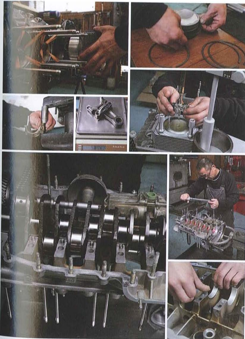
エンジンを仮組し、カムのプロフィールを確認。これによって、ピストンのトップボリュームを確認・決定し、圧縮比を導きだす。再び分解し、ピストンヘッドの加工を依頼。戻ったところで、洗浄、組付け、バルタイ調整、仕上げとなる。
