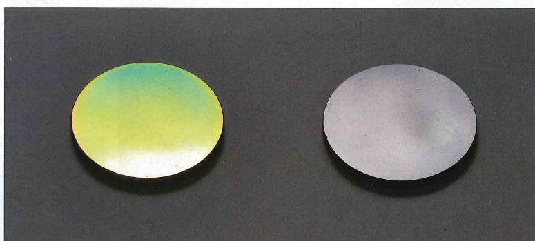
クルマの部品には、疲労強度、耐摩耗性、低フリクション、油膜保持の4つがおもに求められる。そのため、その生産過程では、さまざまなパートにあらゆる表面処理がなされている。しかし、その多くは量産に向いたもので、性能だけを考えると、必ずしも最高とはいえないものもあるという。それは不二WPCが誇る表面処理技術であるDLCコーティングでも同じこと。表面強度の向上や低フリクションなどの効果が知られているが、そのコーティングが施せるのは硬い金属のみ。アルミニウムには密着しにくいとか、焼結素材には処理できない。また、被膜は硬く、密着性は高いものの、油膜が介在する環境下では、未処理の金属と比較して劇的な差があるわけではない。しかし、油膜による潤滑ができる環境下、または油膜切れが起こる可能性がある環境においては、その高い摺動性を発揮し、トラブルを回避してくれるのだ。
