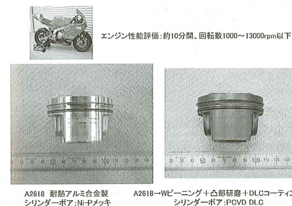
図8 ピストン適用における耐摩耗性改善
